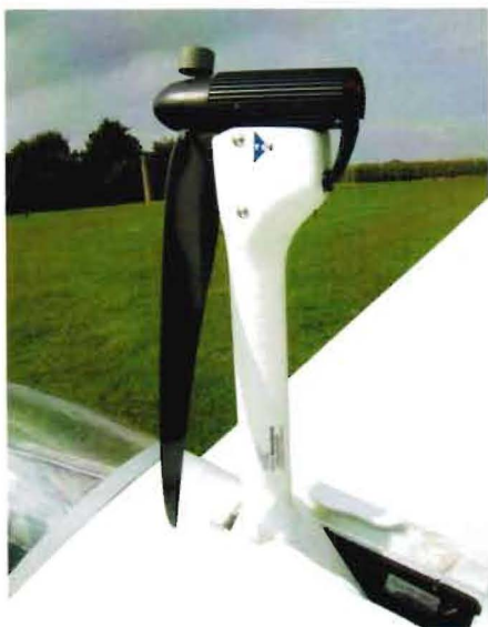
Der Funktionsarm des Klapptriebwerks mit dem Einblattpropeller und Gegengewicht. ▼
