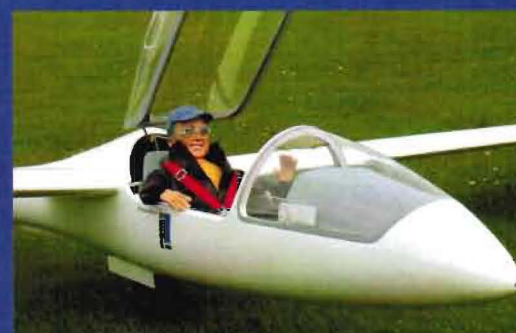
Die Kanzel ist nach hinten aufklappbar. Der Mechanismus stammt von Airworld. Fritz scheint zufrieden zu sein; er stammt aus dem Pilotenpuppen-Sortiment von Spessart-Modellbau. ▼
