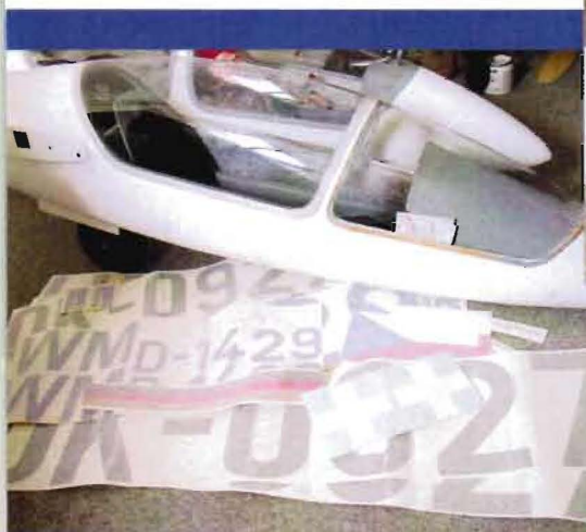
◀ ▲ Ein so großes Cockpit muss ausgebaut werden. Die Sitzwanne stammt von HB-Modellbau und liegt dem Bausatz bei. Das Instrumentenpanel ist in Eigenregie entstanden und verdeckt die Position der Antriebsakkus und der Schleppkuppelung. Die Dekors stammen aus dem Plotter von Michael Stumpf. Nahezu jede Größe und Farbe kann geplottet werden.
