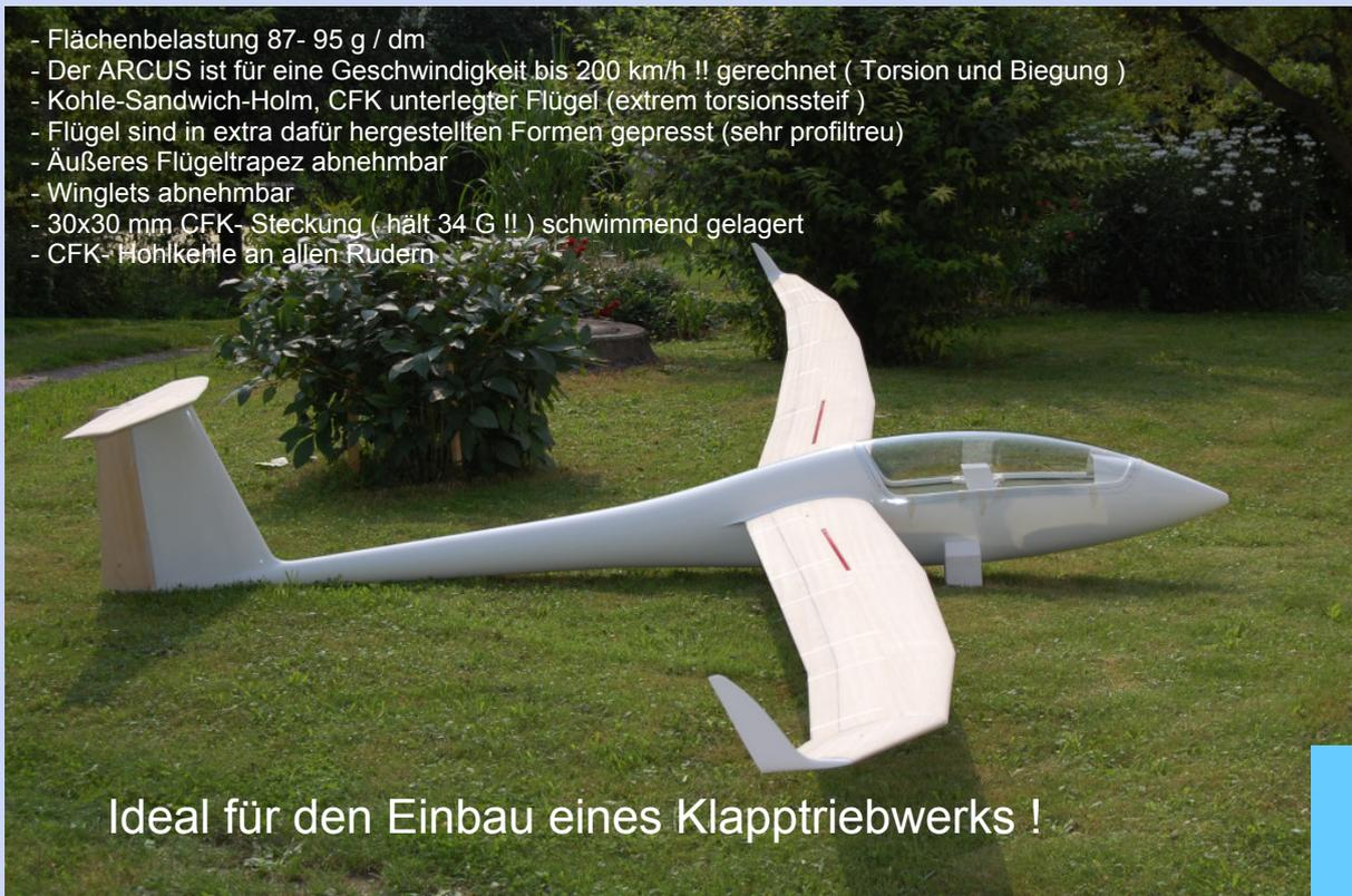
Ideal für den Einbau eines Klapptriebwerks !
